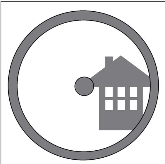
**4.2.** Blicken Sie nun durch das Sucherfernrohr. Sie sehen das gleiche Gebäude, jedoch noch nicht zentriert. Justieren Sie das Sucherfernrohr mit den zwei Justageschrauben (siehe Bild), damit die Position des Objekts wandert. Ein Austesten der Justageschrauben und der damit verbundene Richtungswechsel sind notwendig, um ein erfolgreiches Ergebnis zu erzielen.
