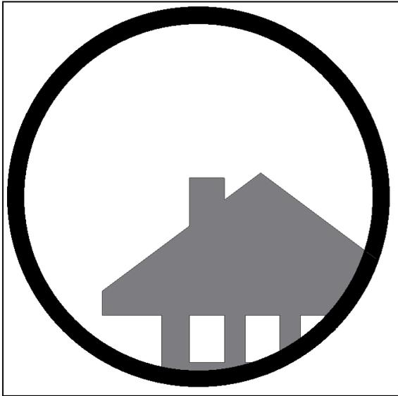
**4.1.** Zentrieren Sie ein entferntes Objekt in der Mitte des Teleskops. Dieses Beispiel zeigt ein Haus mit dem Kamin im Zentrum. Der Kamin ist der Referenzpunkt, den Sie in die Mitte des Gesichtsfeldes des Hauptinstruments einstellen müssen. Blicken Sie zuerst mit der kleinstmöglichen Vergrößerung durch das Teleskop, denn damit haben Sie das größte Gesichtsfeld.
