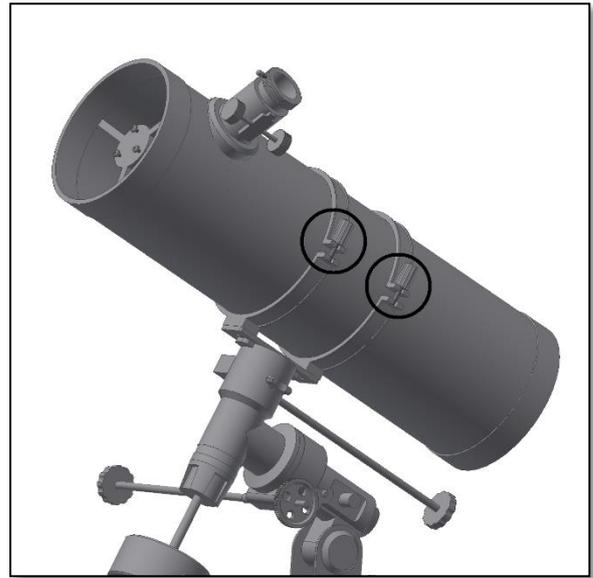
Figure 9. Verwendung der zwei Schrauben, um das Rutschen des Tubus zu verhindern.
