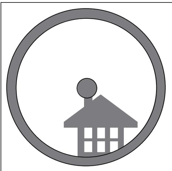
**4.3.** Nach dem "Spielen" mit den beiden Justageschrauben (und einigem Austesten, in welche Richtung das Fadenkreuz bei einer bestimmten Aktion wandert), können Sie das Fadenkreuz auf das Zentrum des Objekts positionieren (in dem Fall der Kamin). Das Sucherfernrohr ist jetzt bereit für die Nutzung.
